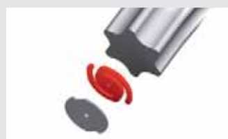
El muelle de retención es una solución técnica totalmente nueva que se coloca en la punta de la varilla y se suelda por láser a ésta junto con una fina arandela.
