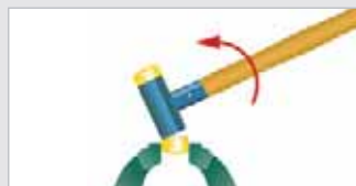
El relleno especial metálico del cabezal evita el retroceso del martillo.
