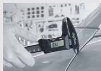
Los brazos de medición de los pies de rey reforzados con fibra de vidrio permiten medir superficies delicadas y pulidas sin arañarlas.
