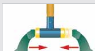
Intercambio sencillo de los cabezales desgastados.
